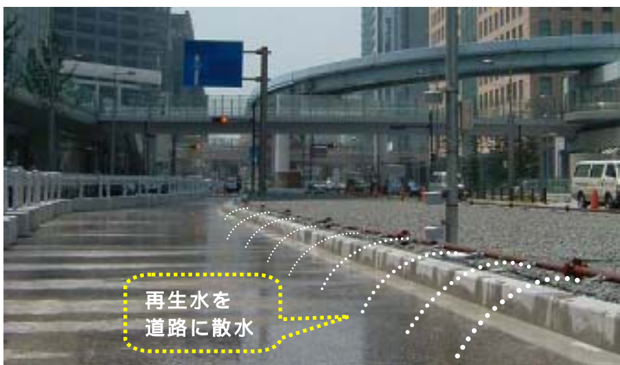
ヒートアイランド対策（汐留地区）
