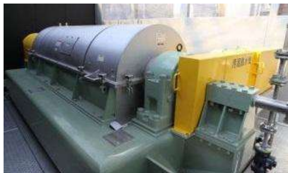
機内二液調質型遠心脱水機
