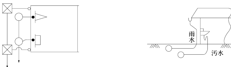
図4-2-3 分流式の排水管の埋設位置
