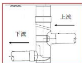
図4-3-9 段差解消ます
