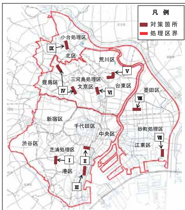
図 3-8 下水道幹線の老朽化対策箇所
