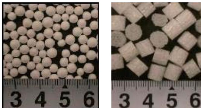
ポリスチレン(PS) 球形(直径3mm)      エチレン-酢酸ビニル樹脂(EVA) 円柱状(直径・長さ7mm)
