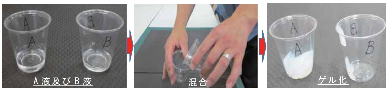
図2 「薬液注入工のゲルタイム」の実演状況
