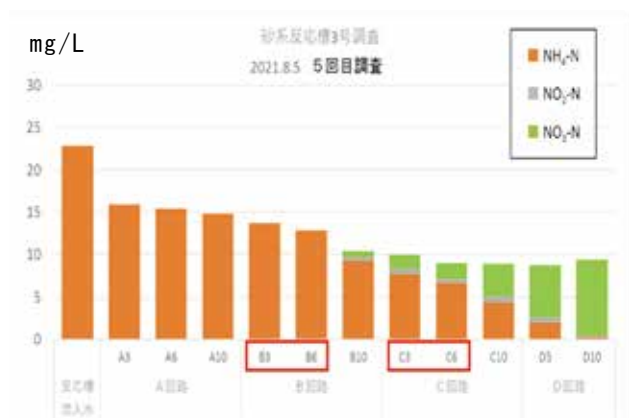
図8 砂系反応槽3号 各回路の窒素 5回目調査（令和3年8月5日）
