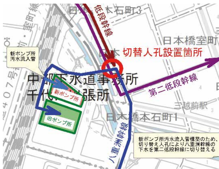
図 2 八重洲幹線切替概要図
