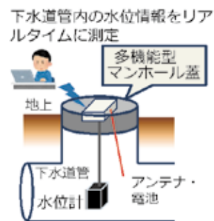
図 1 多機能型マンホール蓋の概要
