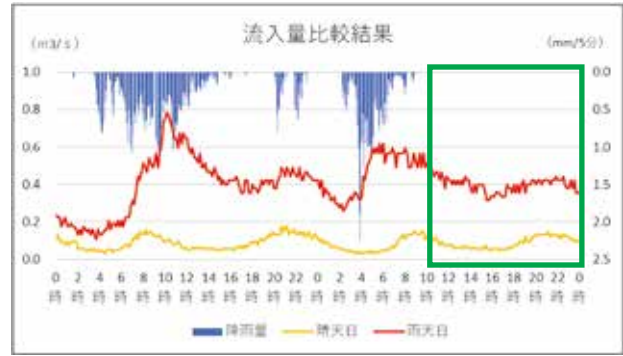
図 5 間接浸入水の影響が大きい箇所
