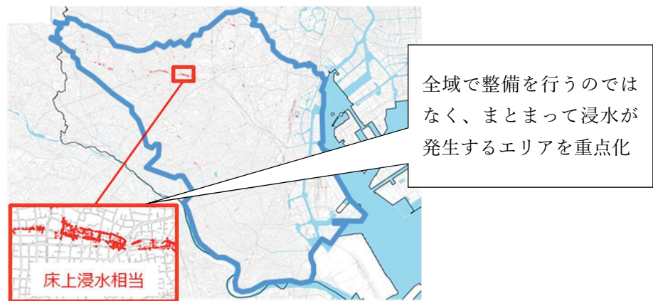
図表 3-2 1時間75ミリの流出解析シミュレーションイメージ
