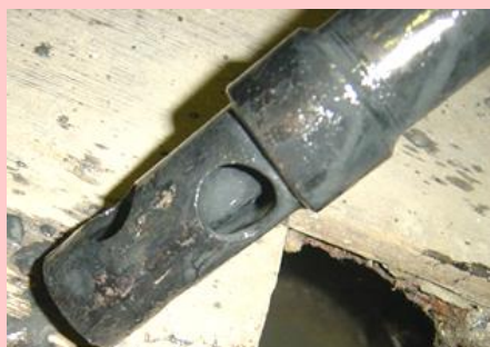
洗淨不良により汚れが付着したpH計
